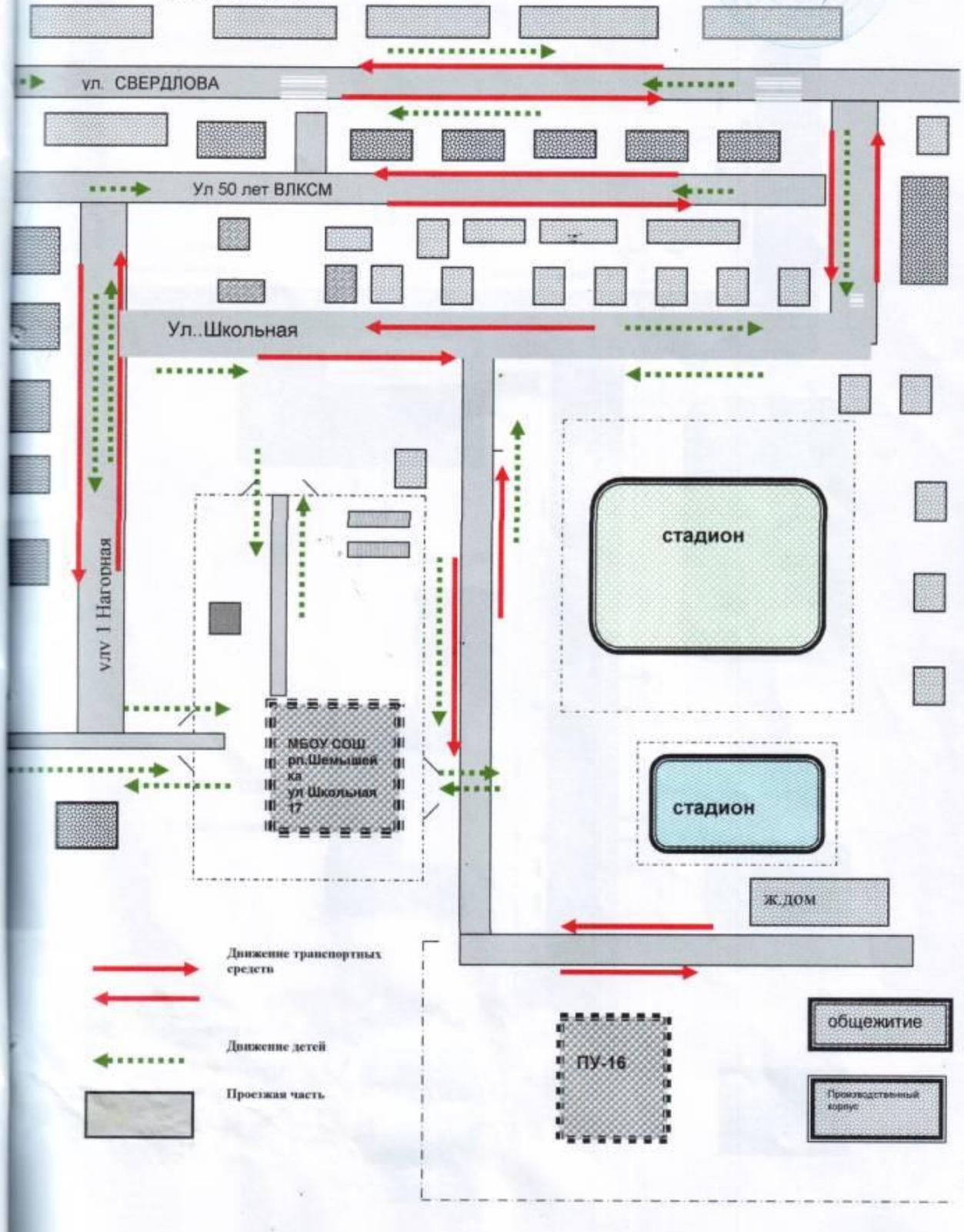
Схема организации дорожного движения в непосредственной близости от МБОУ СОШ р.п.Шемышейка с размещением технических средств, маршруты движения.
